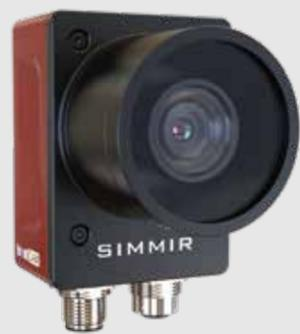
EventCAM 2D是辛米尔研发的工业事件记录系统。硬件上，内嵌高性能SOC，提供4K超高分辨率和240fps超高帧率。软件上，高性能ISP和低延时视频编码IP保证图像清晰可靠，同时具备工业数据采集、工业事件记录和协议推流功能，可对接 PLC 或机器人，实时获取控制系统内的状态，包括故障报警、产品生产、工件扫码等，并基于工业事件自动生成的短视频记录，覆盖事件发生前后的视频片段，只保留有用视频。同时，它作为工业智能相机，具备完善的工业总线通讯协议，便于产线集成。
