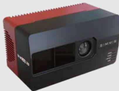
EventCAM 3D在底层与EventCAM 2D保持同构，软件操作方式上保持一致，功能涵盖AI EventCAM 2D现有特性，在此基础上加入3D图像采集与计算。EventCAM 3D既有传统3D相机功能，也内嵌完整处理系统，即可对外传输高质量RGB-D图像，也支持在不连接工控机的情况下，依靠自有AI处理器完成计算。因内嵌自研视频理解算法，EventCAM 3D支持多种开箱即用功能，使用上高度便捷，系统延迟上远优于分离式架构，可在多种场景中使用，旨在进一步降低3D+AI的应用门槛，零代码部署。
