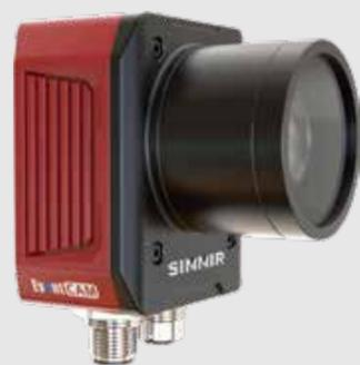
AI EventCAM 2D是辛米尔研发的AI视频事件侦测与记录系统，是基于EventCAM 2D的升级，包含所有EventCAM 2D产品的既有功能，在此基础上配备AI引擎和DSP引擎，加强了边缘端AI视频处理能力，内部运行轻量化的视频理解算法模型。硬件上，同样可提供4K超高分辨率和240fps超高帧率，基于异构芯片架构平台开发，针对自研视频理解AI模型进行深度优化。成像方面，内嵌低延时视频编码IP和ISP模块。软件上，内部运行实时操作系统，可实现人员存在性检测、动作分类、轨迹分类、异常检测等视频理解功能。
